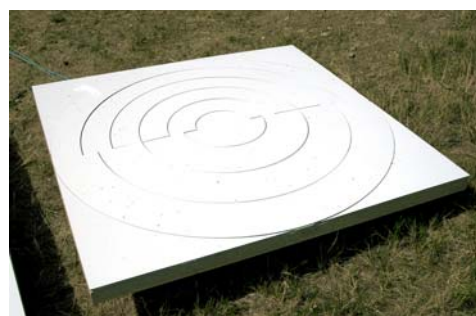
la mire prête pour l'installation sur le terrain
